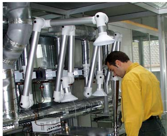
Bild 15 Fotografische Aufnahme einer Prüfkammer zur Emissionsbestimmung bei Bauprodukten (Bild links) und human-olfaktometrische Charakterisierung von Produkten im Prüfkammerversuch (Bild rechts).
