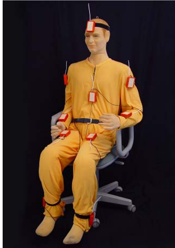
Bild 6 Bilder links, oben und unten: Fotografische Aufnahmen von Probanden während der thermischen Behaglichkeitsuntersuchungen, die am IBP durchgeführt wurden. Bild rechts: DRESSMAN ( D ummy R epresenting S uit for S imulation of H uman H eatloss).
