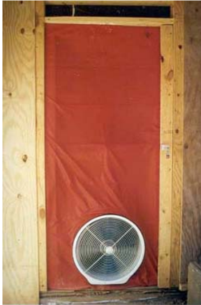
Bild 4 Blower-Door-Messung; links: fotografische Aufnahme einer Blower-Door-Messeinrichtung an einer Tür. rechts: Schematische Darstellung des Messprinzips.
