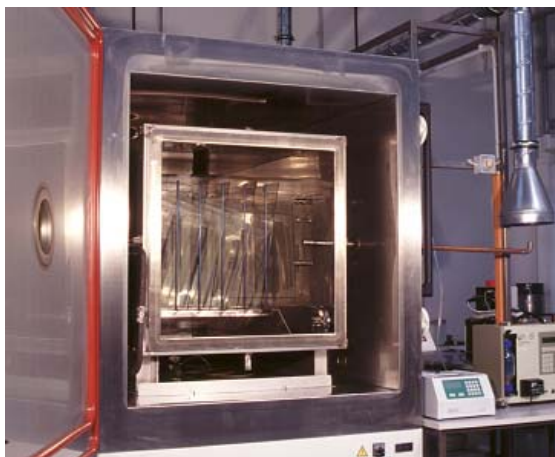
Bild 15 Fotografische Aufnahme einer Prüfkammer zur Emissionsbestimmung bei Bauprodukten (Bild links) und human-olfaktometrische Charakterisierung von Produkten im Prüfkammerversuch (Bild rechts).
