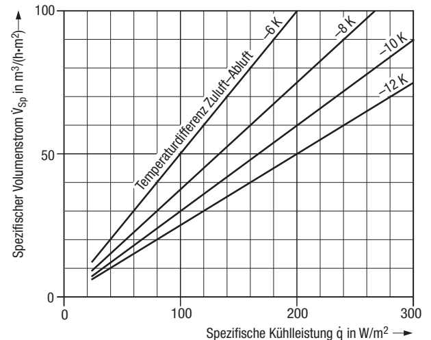
Bild 6: Zusammenhang zwischen spezifischer Kühllast, Temperaturdifferenz und spezifischem Luft-Volumenstrom
