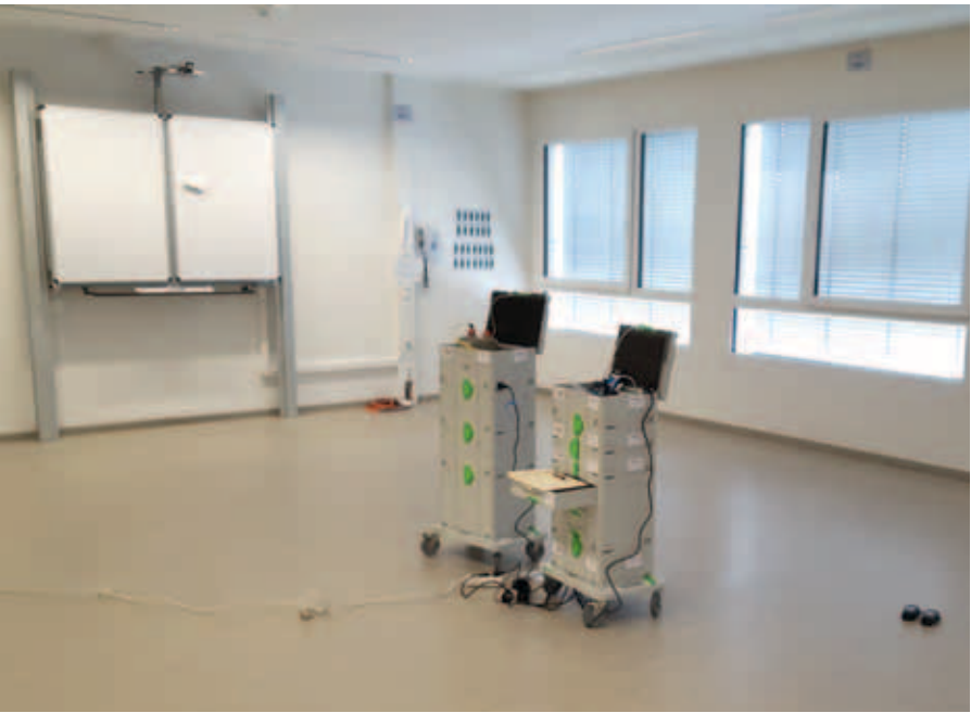
Messanordnung für die Raumlufbmessung in einem Schulgebäude
