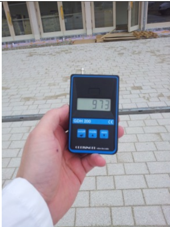
Luftdruckmessung außen für die standardisierte TENAX TVOC Messung in der Turnhalle – DIN 16000 ff
