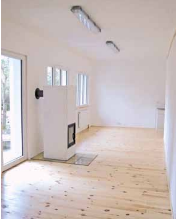
Kalk als Anstrichmittel wirkt geruchsbindend und trägt zur Verbesserung der Raumluft bei. Die ehemalige Lagerhalle stand jahrelang leer. Durch den Anstrich mit reiner Kalkfarbe ließ sich der muffige Geruch dauerhaft beseitigen.
