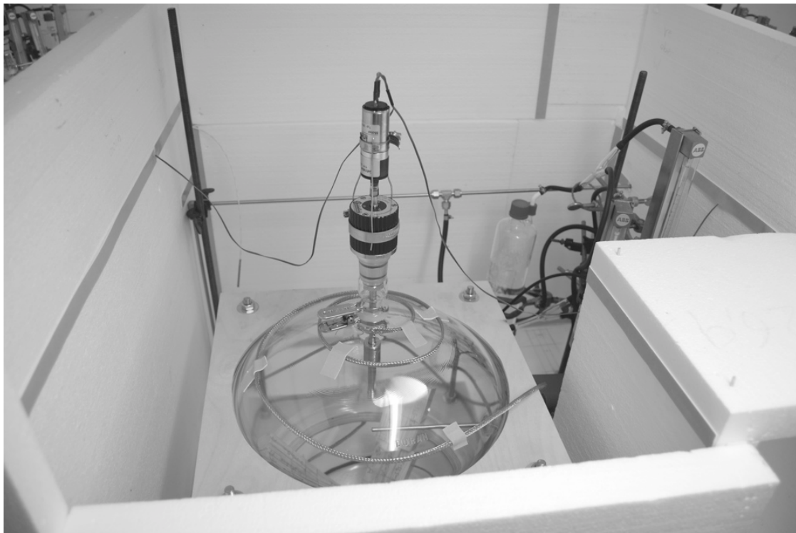
Abbildung 3: Prüfkammer mit Heizband und (teilweise geöffnet) Einhausung
