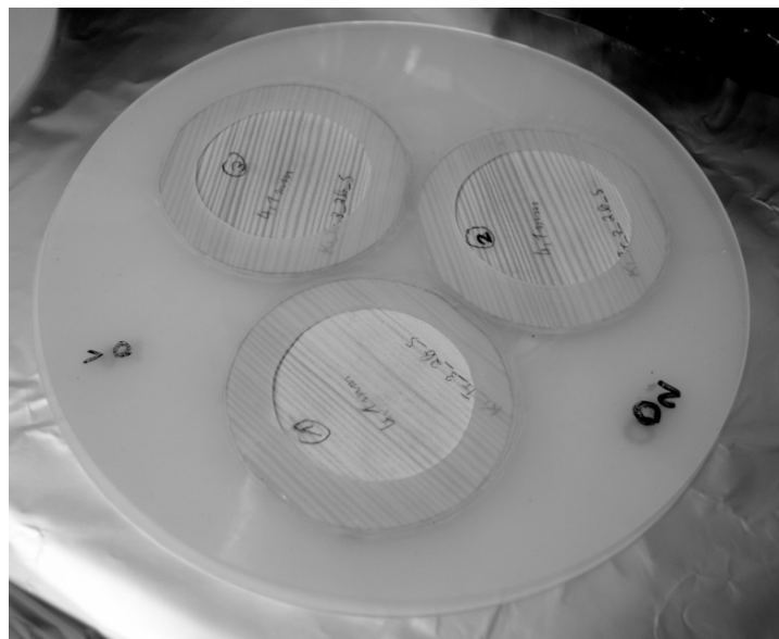
Abbildung 40: Silikonmatten mit Ausschnitten und eingeklebten Probenkörpern
