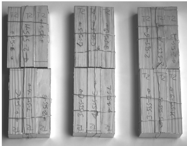
Abbildung 2: Aus 18 Abschnitten zusammengesetzte Probe für einen Emissionstest
