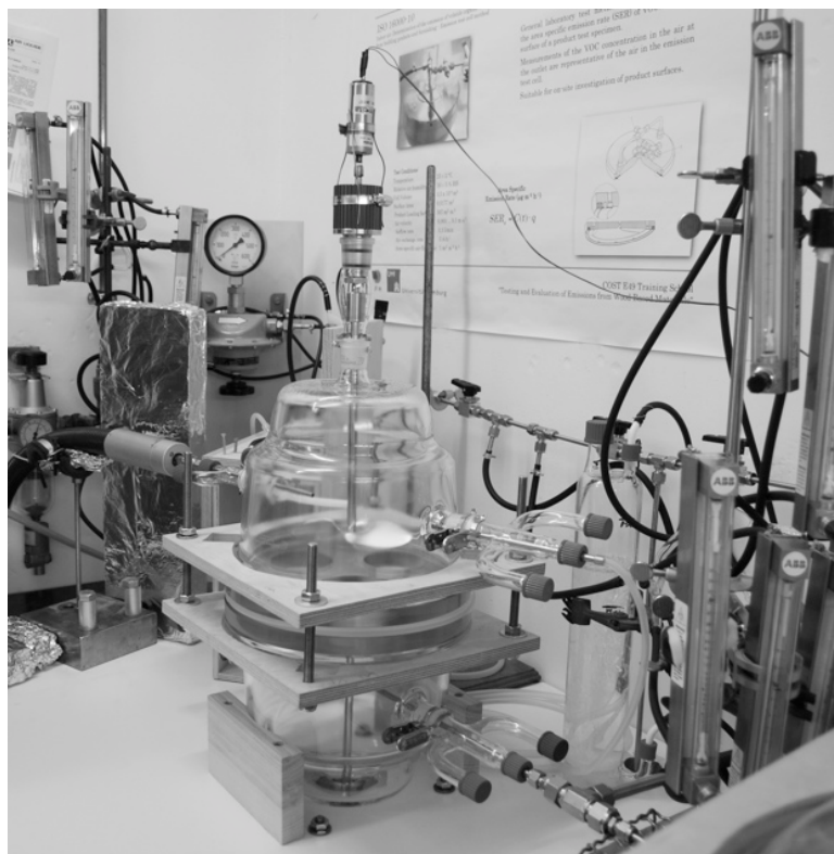
Abbildung 38: Doppelkammeraufbau zu Messung der Diffusion flüchtiger Substanzen durch Vollholz und Holzwerkstoffe
