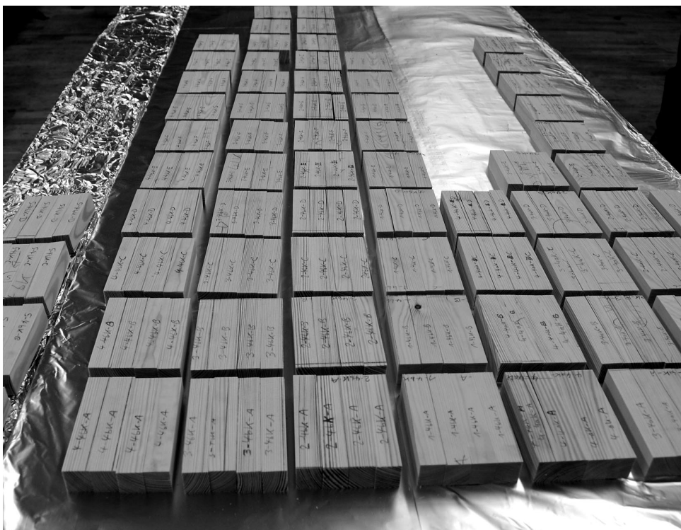
Abbildung 1: Abschnitte aus Probebrettern zur Herstellung homogener Proben
