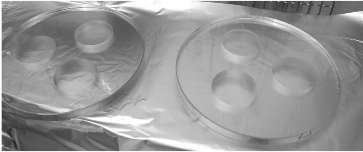
Abbildung 39: Glasplatten mit Ausschnitten zur Einbringung der Probenkörper in die Doppelkammer
