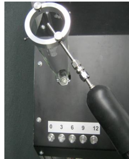
Abbildung 12: Messstutzen des FIDs am Trichter des Vergleichsmaßstabs.
