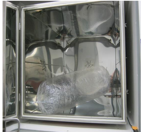
Abbildung 40: Nalophan-Beutel in einer Emissionsprüfkammer zur thermischen Behandlung.
