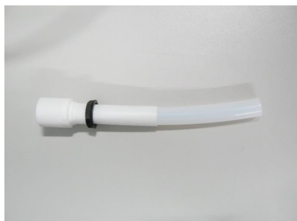
Abbildung 54: Beuteladapter mit Teflonröhrchen für die indirekte Geruchsbewertung. Links: schmaler Durchmesser (8 mm). Rechts: großer Durchmesser (12 mm).
