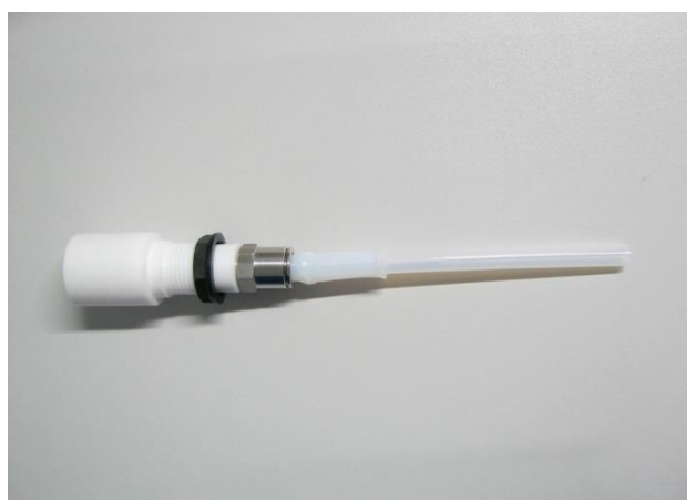
Abbildung 54: Beuteladapter mit Teflonröhrchen für die indirekte Geruchsbewertung. Links: schmaler Durchmesser (8 mm). Rechts: großer Durchmesser (12 mm).
