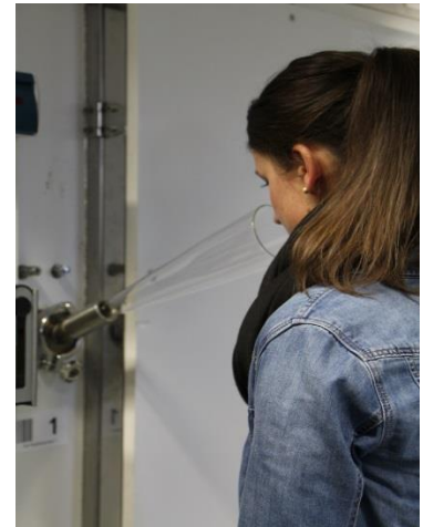
Abbildung 8: Direkte Geruchsbewertung an einer 3\text{m}^3 -Prüfkammer.
