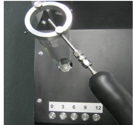
Abbildung 58: Messstutzen des FIDs am Trichter des Vergleichsmaßstabs.
