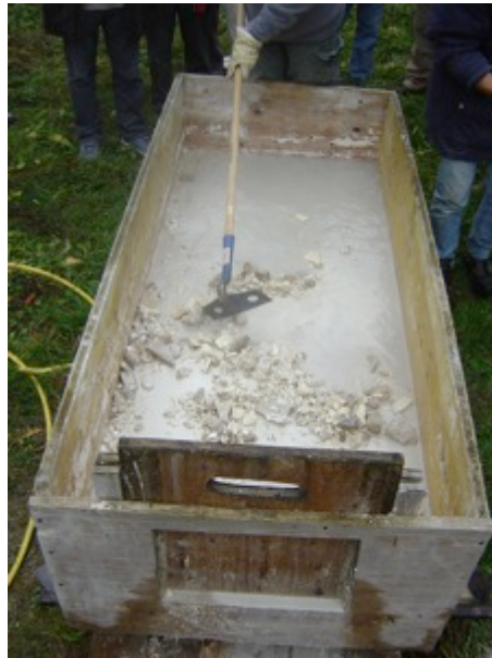
Bild 32: Wellwall, Sumpfkalk- Becken
