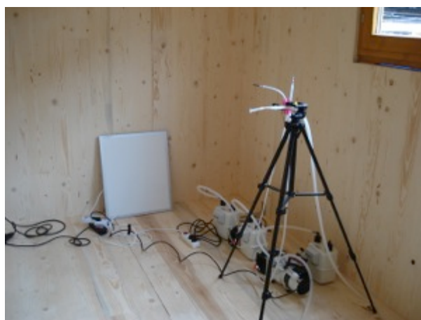
Bild 21: IQUH Messstudie: Schadstoffmessung in der Klimabox
