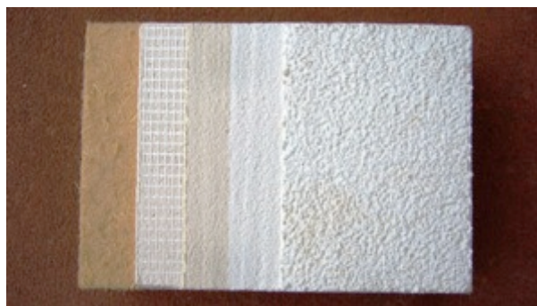
Bild 30: Wellwall Dämmaufbau Kalkleichtputz
