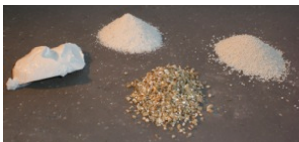
Bild 13: Wellwall Rohstoffabbildungen zu Putzen von links im Uhrzeigersinn: Sumpfkalk, Marmorsand, Glasgranulat, Vermiculite
