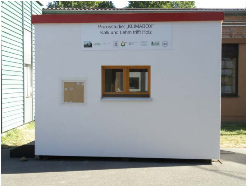
◀ Praxisstudie: Die „KLIMABOX“ dient zur Überprüfung von Emissions- richtwerten im Holzbau
