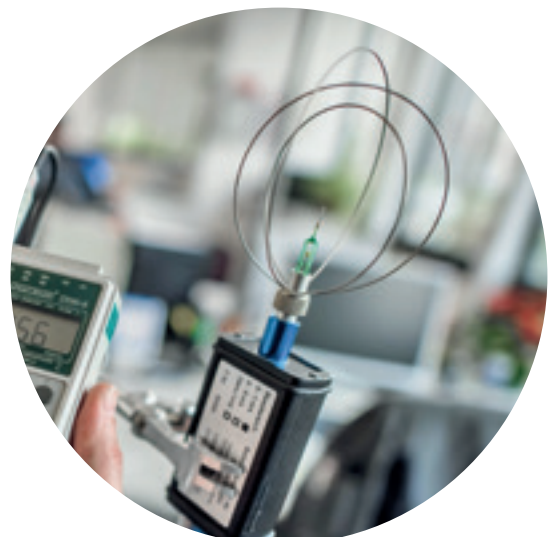
Messung der Luftgeschwindigkeit
