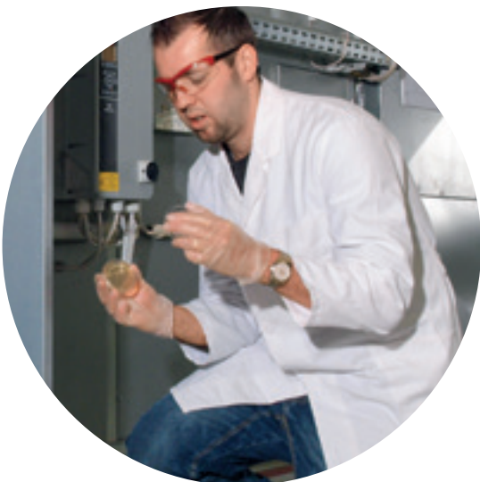
Abklatschprobe in einer Lüftungszentrale
