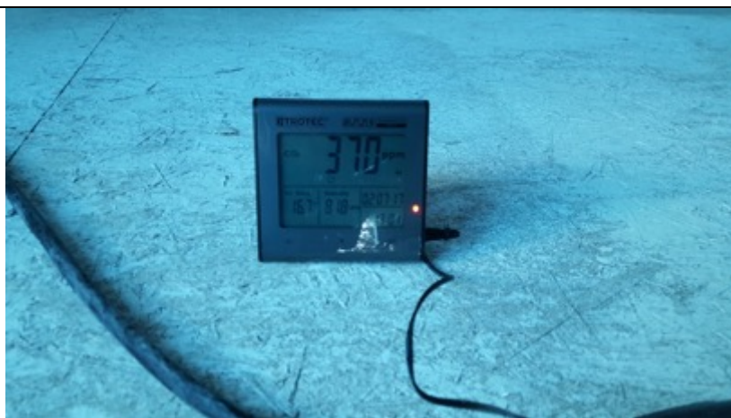
Niedrige CO2 Konzentratione bedingt durch die hohe Windlast von Außen und die undichte Gebäudehülle
