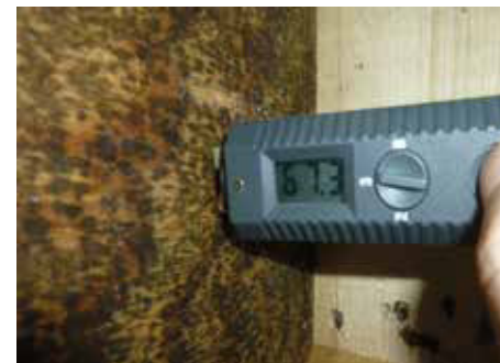
Pilzbelastung durch hohe Baufeuchte wegen Estrich- und Putzeinbau an der Dachunterseite innen, IQUH
