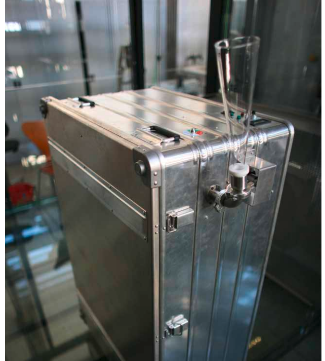
Bild 13 Das selbst entwickelte Probenahme- und Probendarbietungsgerät Air Probe des Hermann-Rietschel-Instituts (HRI). An der rechten Seite ist ein Bewertungstrichter aus Glas erkennbar. Für die Geruchsmessung der gleichmäßig ausströmenden Luftprobe hält der Proband ihre Nase über den Trichter.
