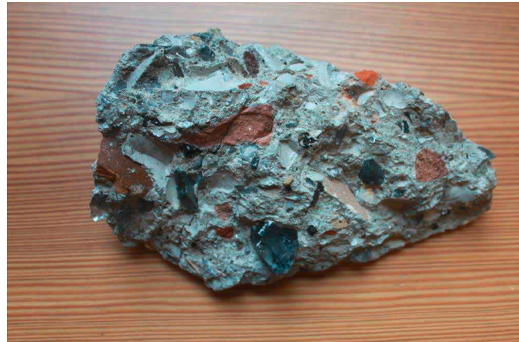
Bild 16 Ein Betonfertigteil, das Bildschirmglas enthält.
