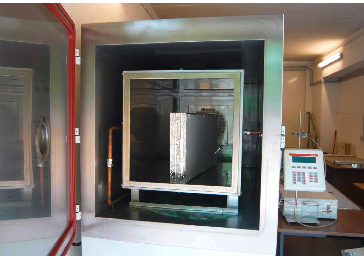
Bild 7 Emissionskammer mit der Materialprobe von OSB-Platten hinter Gipskarton.
