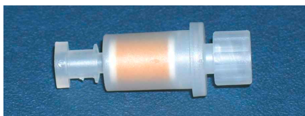
Bild 11 Kommerzielle Sammelkartusche, die DNPH auf einem Kieselgelträger enthält, für die Adsorption von Aldehyden und Ketonen.
