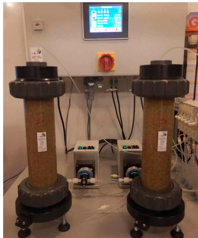
Bild 16 Prüfung eines körnigen Bauprodukts im Säulentest.
