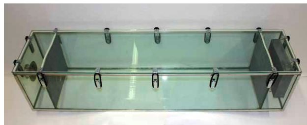
Bild 8 Ansicht der Emissionskammer CLIMPAQ (Chamber for Laboratory Investigations of Materials, Pollution and Air Quality), die hier ein Fassungsvermögen von etwa 35 Litern hat. Der Raum, in den die Materialprobe eingebracht wird, ist jeweils auf der Seite der Luftzuführung und der Luftabführung durch eine Drahtgaze abgetrennt. Sie bewirkt, dass der Luftstrom laminar über die Materialprobe hinweg streicht.
